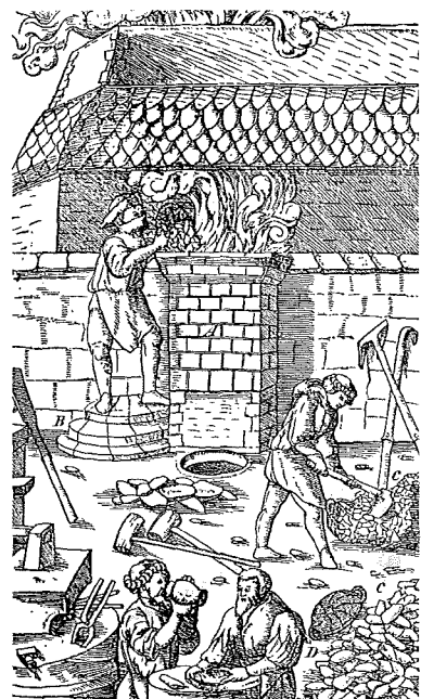
Figur 5.22. Ældre stik der viser primitiv oparbejdelse af jernmalm til jern; ved reduktion med kul, kan malmen omdannes til en smedelig jernsvamp af \text{Fe} , uden på noget tidspunkt at have været smeltet.
