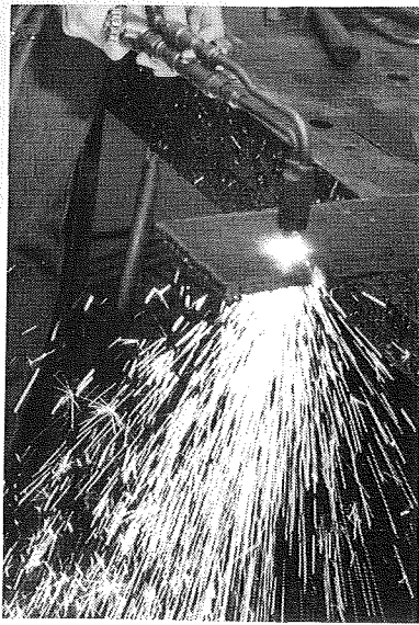
Figur 3.47. Flammeskæring af stål. En skarpt afgrænset stråle af ren ilt forbrænder (oxiderer) og bortsmelter stålet i skærezonen; processen er stærkt eksoterm, således at oxygentilførslen sikrer en fortsat opvarmning af stålet i skærezonen.
