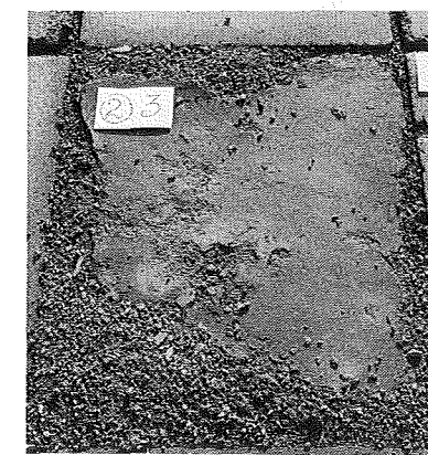
Figur 4.15. Frostnedbrydning af beton fremkaldes af porevandets udvidelse ved frysning, dvs. ved faseomdannelsen \text{H}_2\text{O}(\ell) \rightarrow \text{H}_2\text{O}(\text{s}) . Foto viser frostskeer på en betonflise.
